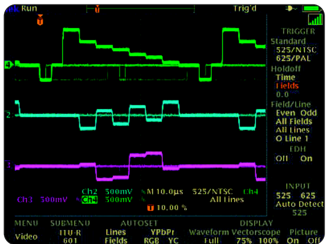
► 使用 TDS3SDI 601 串行数字视频模块，跟踪和识别 ITU-R BT.601 视频信号。
