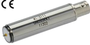
1/2英寸驻极体电容传声器用前置放大器。可使用定电流驱动方式驱动，采用BNC型信号端子，可直接连接支持定电流驱动方式的各种分析仪，放大器，记录仪等使用。符合CE标准，采取了EMC对策处理，抗干扰能力强。
