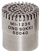
声场型1/2英寸背极式驻极体型测量用传声器。不需要提供偏置电压，使用方便。传声器的心脏部的振动膜采用钛合金，并使用激光焊接的新技术。适合用于环境噪声，建筑声学以及电子电器与机械设备的放射噪声的测量及分析应用。与MI-3111等传声器用前置放大器配套使用。
